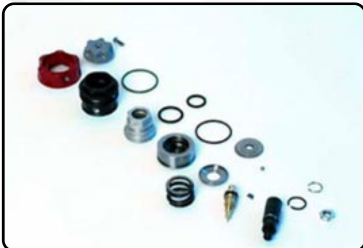
Ensemble des constituants du mécanisme de la DCC.
