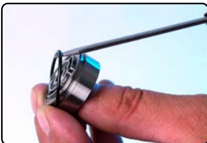
Démontez le joint torique.
